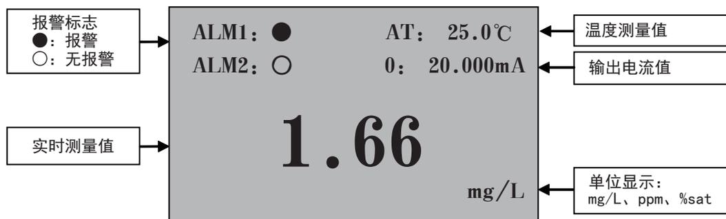
注：当测量值显示“— — — —”时，表示超量程或电极没插入溶液中。
